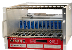
7U 12 slot smart fan unit 300/600 W Crate
